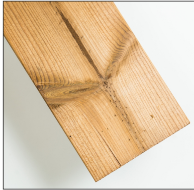
Trhliny na koncích prken jsou povoleny
