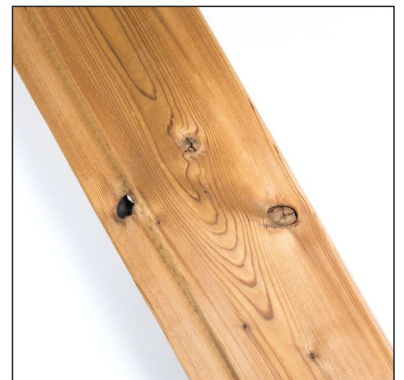
Malé otvory po vypadlých sucích jsou povoleny
